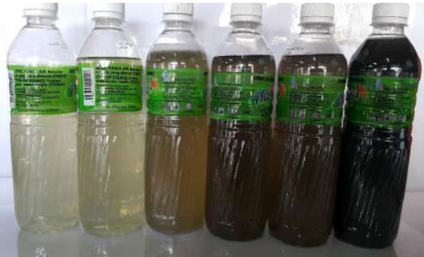
Gambar menunjukkan PPO sistem, keadaan asal efluen dan hasilnya setelah dirawat. dalam masa sejam
