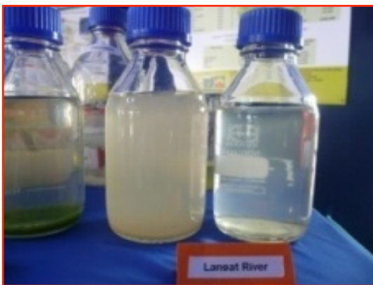
Keupayaan biopolimer untuk merawat air tercemar secara berkesan dibuktikan melalui ujian balang terhadap air Kolam Serdang dan air Sungai Langat.
