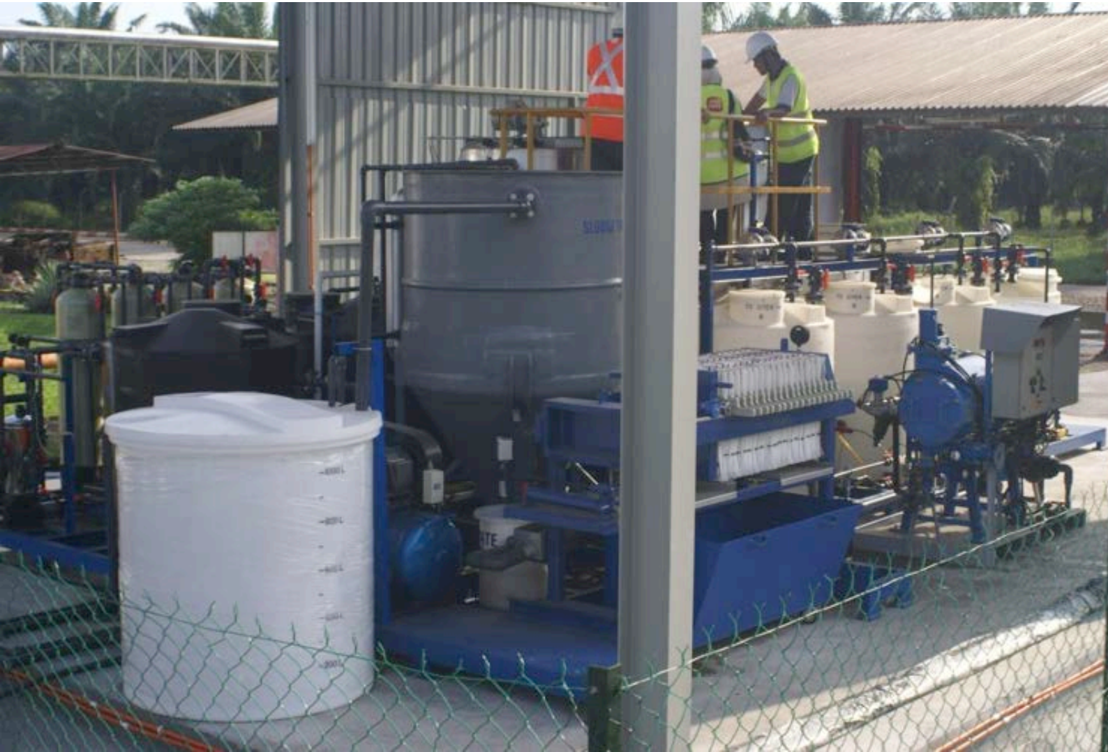
Sistem POMEF yang diletakkan di Sime Darby East Mill, Carey Island, dengan unit elektro pengental yang diletakkan di bahagian akhir sistem tersebut
