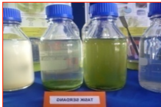
Keupayaan biopolimer untuk merawat air tercemar secara berkesan dibuktikan melalui ujian balang terhadap air Kolam Serdang dan air Sungai Langat.
